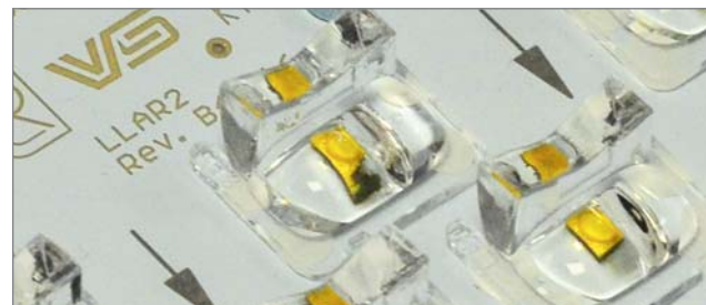
Lentilles de la version asymétrique. Lenses of the asymmetrical version.
