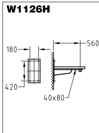
Wandarm aus feuerverzinktem Stahl mit geradem Ausleger und Zierstrebe unten für Schirmleuchten. Leuchtenbefestigung mit R1/2"- oder R3/4"-Innengewinde, hängend.
