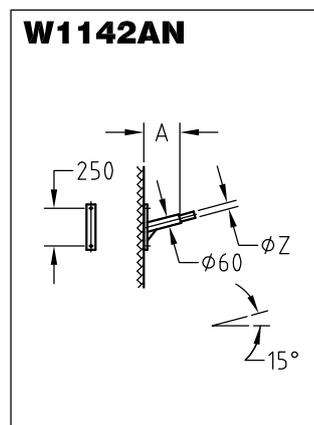
Wandarm mit geneigtem Ausleger aus feuerverzinktem Stahl für Ansatz-Kofferleuchten. Ausladung A und Stützenmaße  $\phi Z$  variabel. Auch mit Wandschild für Eckbefestigung lieferbar.
