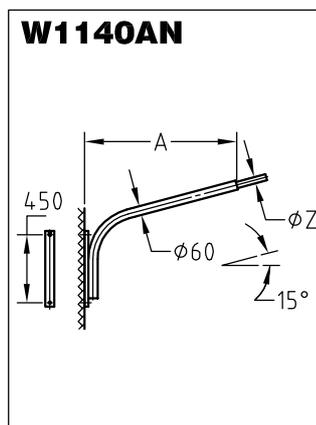
Wandarm mit geneigtem Ausleger aus feuerverzinktem Stahl für Ansatz-Kofferleuchten oder Langfeldleuchten. Ausladung A und Stützenmaße  $\phi Z$  variabel. Auch mit Wandschild für Eckbefestigung lieferbar. Zur Befestigung an Holzmasten geeignet.
