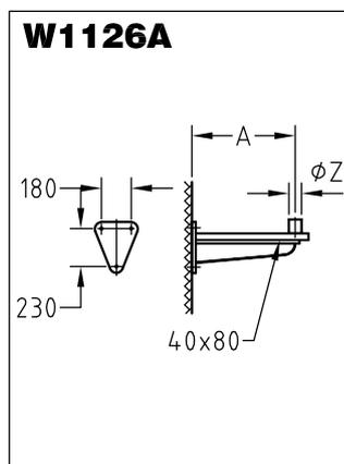
Wandarm aus feuerverzinktem Stahl mit geradem Ausleger und Zierstrebe unten für Aufsatzleuchten. Stützenmaß  $\phi Z$  variabel. Auch mit Wandschild für Eckbefestigung lieferbar.
