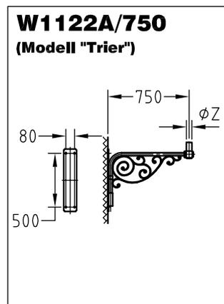
Wandarm aus feuerverzinktem Stahl für Leuchten mit historischem Charakter, schmiedeeiserne Verzierung, Aufsatzbefestigung, Stützenmaß  $\phi Z$  variabel. Der Ausleger ist schwenkbar. Auch mit Wandschild für Eckbefestigung lieferbar.
