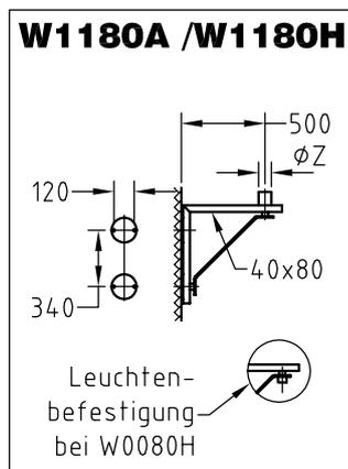
Wandarm aus feuerverzinktem Stahl mit Winkel-Ausleger 90° und Zierstrebe unten für Aufsatzleuchten oder Schirmleuchten. Leuchtenbefestigung Aufsatz (Typ W1180A, Stützenmaß  $\phi Z$  variabel) oder hängend (Typ W1180H) mit R1/2"- oder R3/4"-Innengewinde.
