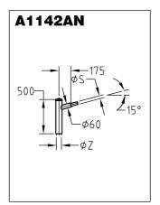
Mastaufsatzstück mit geneigtem Ausleger aus feuerverzinktem Stahl für Ansatz-Kofferleuchten. Ausladung, Neigung, Stutzenmaße ØS und Aufsatzmaß ØZ variabel. Lieferbar als 1- bis 4-fach-Aufsatzstück (A1142/1 bis A1142/4).
