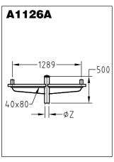
Mastaufsatzstück mit geraden Auslegern aus feuerverzinktem Stahl für zylindrische Aufsatzleuchten oder Leuchten mit historischem Charakter. Leuchtenbefestigung Aufsatz. Aufsatzmaß ØZ und Leuchtenbefestigung variabel. Lieferbar als 2- bis 4-fach-Aufsatzstück (A1126A/2 bis A1126A/4)
