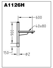
Mastaufsatzstück mit geradem Ausleger aus feuerverzinktem Stahl für Schirmleuchten. Hängende Leuchtenbefestigung an R1/2" oder R3/4"-Innengewinde.
