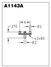
Mastaufsatzstück aus feuerverzinktem Stahl für Aufsatz-Kofferleuchten. Ausladung A, Stutzenmaße ØS und Aufsatzmaß ØZ variabel. Lieferbar als 2- bis 4-fach-Aufsatzstück (A1143/2 bis A1143/4).
