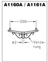
Mastaufsatzstück mit geneigten Auslegern aus feuerverzinktem Stahl für Leuchten mit historischem Charakter. Leuchtenbefestigung Aufsatz. Aufsatzmaß ØZ und Leuchtenbefestigung variabel. Lieferbar als 2- bis 5-fach-Aufsatzstück (z. B. A1160A/2 bis A1160A/4).
