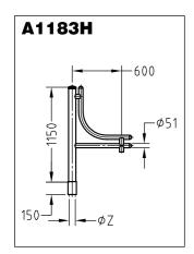
Mastaufsatzstück mit geradem und gebogenem Doppelrohr-Ausleger aus feuerverzinktem Stahl für Schirmleuchten. Hängende Leuchtenbefestigung an R1/2" oder R3/4"-Innengewinde.
