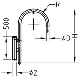
Mastaufsatzstück mit seitlich angesetztem Bogenausleger aus Aluminium oder feuerverzinktem Stahl für Schirmleuchten. Ausführungen für Leuchtenbefestigung im oder am Bogen an R1/2" oder R3/4"-Innengewinde. Aufsatzmaß ØZ variabel.
