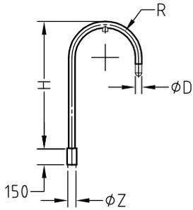
Mastaufsatzstück mit aufgesetztem Bogenausleger aus feuerverzinktem Stahl für Schirmleuchten. Ausführungen für Leuchtenbefestigung im oder am Bogen an R1/2" oder R3/4"-Innengewinde. Aufsatzmaß ØZ variabel.
