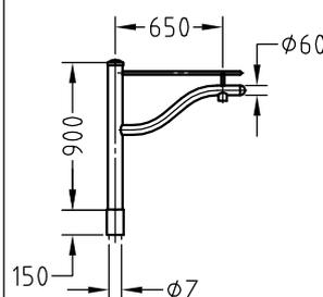
Mastaufsatzstück mit doppelt gekrümmtem Ausleger und Strebe aus feuerverzinktem Stahl für Schirmleuchten. Hängende Leuchtenbefestigung an R1/2" oder R3/4"-Innengewinde. Aufsatzmaß ØZ variabel. Optional mit Zierkugel.
