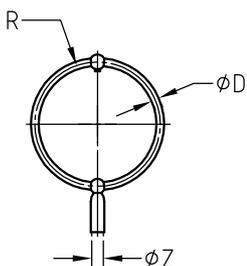
Mastaufsatzstück mit aufgesetztem Rohrkreis aus feuerverzinktem Stahl für Schirmleuchten. Mit zwei Zierkugeln. Hängende Leuchtenbefestigung im Ring an R1/2" oder R3/4"-Innengewinde. Aufsatzmaß ØZ variabel.
