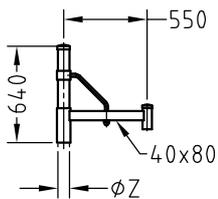
Mastaufsatzstück mit geradem Ausleger aus feuerverzinktem Stahl für Schirmleuchten. Hängende Leuchtenbefestigung an R1/2" oder R3/4"-Innengewinde. Aufsatzmaß ØZ variabel. Optional mit Zierkugel.
