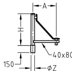
Winkliges Mastaufsatzstück aus Aluminium für Schirmleuchten. Hängende Leuchtenbefestigung an R1/2" oder R3/4"-Innengewinde. 1- bis 3-fach (z. B. A1181H/3).
