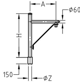
Winkliges Mastaufsatzstück aus feuerverzinktem Stahl für Schirmleuchten. Hängende Leuchtenbefestigung an R1/2" oder R3/4"-Innengewinde (Pl.-Nr. . . .H) oder Aufsatz (Pl.-Nr. . . .A). Aufsatzmaß ØZ variabel. 1- bis 4-fach (z. B. A1180H/4). Optional mit Zierkugel.
