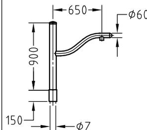
Mastaufsatzstück mit doppelt gekrümmtem Ausleger aus feuerverzinktem Stahl für Schirmleuchten. Hängende Leuchtenbefestigung an R1/2" oder R3/4"-Innengewinde. Aufsatzmaß ØZ variabel. Optional mit Zierkugel.
