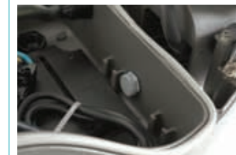
+ Event IP 68 empêche la condensation et régule les variations de pression et de température IP 68 vent prevents condensation and regulates pressure and temperature variations
